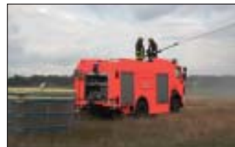
Modernes Tanklöschfahrzeug TLF 24/50 mit einem Wasserwerfer im Betrieb
