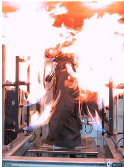
Bild 6: Prüfung der Beflammung nach DIN EN 137:2007 Foto: Deutsche Montan Technologie GmbH
