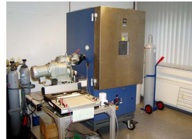
Bild 1: Prüfung auf Temperaturbeständigkeit in einem Temperaturschrank
