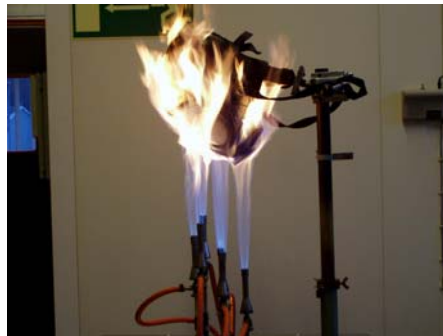
Bild 4: Prüfung einer Vollmaske auf Entflammung
