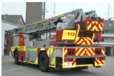
Bild 6 bis Bild 8: Umsetzungsbeispiele der Feuerwehr Raterigen für eine bessere Tages- und Nachtsichtbarkeit der Feuerwehrfahrzeuge (Quelle für alle drei Bilder: Feuerwehr Raterigen)
