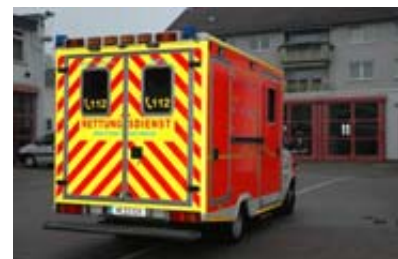
Bild 6 bis Bild 8: Umsetzungsbeispiele der Feuerwehr Raterigen für eine bessere Tages- und Nachtsichtbarkeit der Feuerwehrfahrzeuge (Quelle für alle drei Bilder: Feuerwehr Raterigen)
