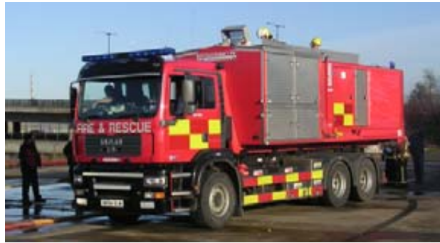
Bild 3: Anwendungsbeispiel für das britische "Battenburg-Design" (Battenburg markings), London Fire Brigade, Großbritannien (Quelle: Dr. de Vries, Hamburg)
