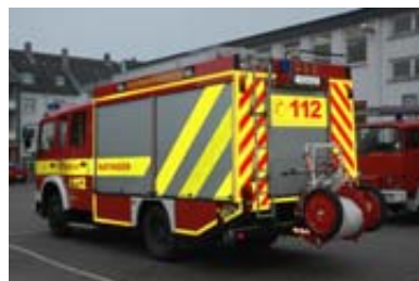
Bild 6 bis Bild 8: Umsetzungsbeispiele der Feuerwehr Raterigen für eine bessere Tages- und Nachtsichtbarkeit der Feuerwehrfahrzeuge (Quelle für alle drei Bilder: Feuerwehr Raterigen)
