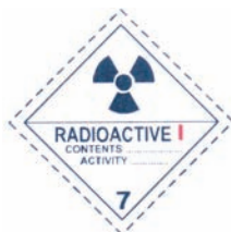
(Nr. 7A) Kategorie I - WEISS Strahlensymbol: schwarz auf weißem Grund; (vorgeschriebener) Text: schwarz in der unteren Hälfte des Gefahrzettels: «RADIOACTIVE» «CONTENTS ...»; «ACTIVITY ...»; dem Ausdruck «RADIOACTIVE» folgt ein senkrechter roter Streifen; Ziffer «7» in der unteren Ecke
