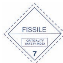
(Nr. 7E) Spaltbare Stoffe der Klasse 7 weißer Grund; (vorge- schriebener) Text: schwarz in der oberen Hälfte des Gefahrzettels: «FISSILE»; in einem schwarz einge- rahmten Feld in der unteren Hälfte des Gefahrzettels: «CRITICALITY SAFETY INDEX» Ziffer «7» in der unteren Ecke
