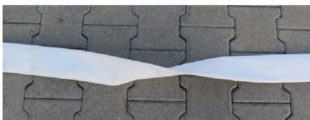
Halbe Schlauchverdrehung -> keine Fehlerpunkte
