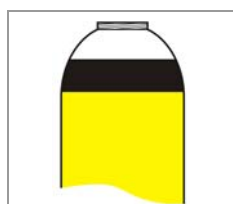
Druckluft für Atemzwecke
