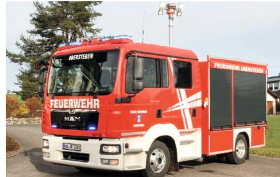
Tragkraftspritzenfahrzeug Wasser TSF-W der Feuerwehr Oberstebben
