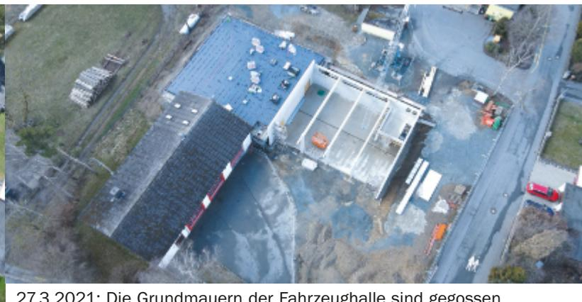
27.3.2021: Die Grundmauern der Fahrzeughalle sind gegossen und die Arbeiten im Innenausbau des Sozialtrakts haben bereits begonnen
